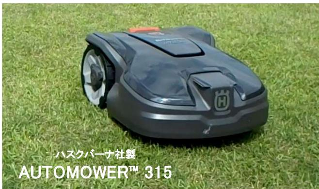
ロボット芝刈機オートモアは、地中に埋められた境界ワイヤー内をランダムな動きで走行して芝を刈ります。オートモアにはバッテリーが内蔵されており、充電が無くなりそうになるとエリア内に設置されたチャージステーションに自ら戻り、充電を開始します（充電が完了すると、再び芝刈りを再開します）。動作する時間帯は予め設定しておく事ができ、スマートフォンのアプリにより、現地にいなくても稼働時間帯や刈高の変更・動作停止等の操作が可能です。
