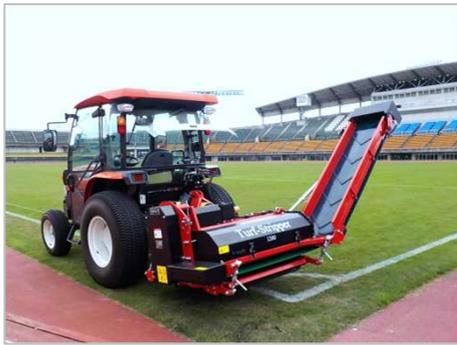
後ろの機械がターフstripper、トラクターで牽引しています。
